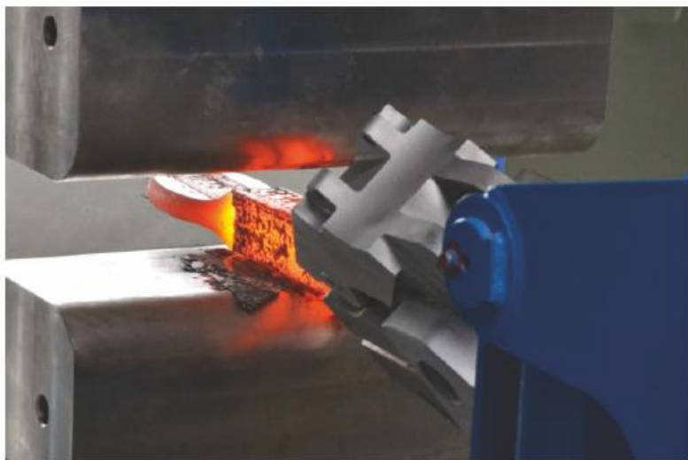
Obr.1 Detail práce kovacího lisu s manipulátorem
