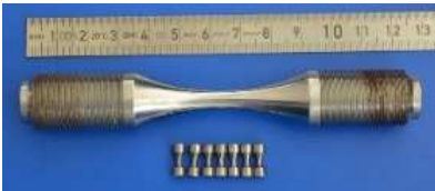
Obr.2 Vyhodnocení vlastností materiálu pomocí malých vzorků, např. únavovými testy
